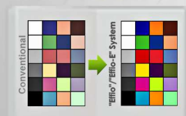
Doskonałe odwzorowanie kolorów poprzez układ Effio, bardzo szeroki zakres ATW (1800K do 10500K)
