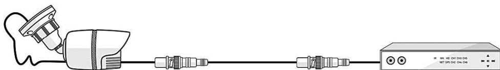
kamera AHD kabel koncentryczny 75 Ohm - przesył do 500m rejestrator AHD
