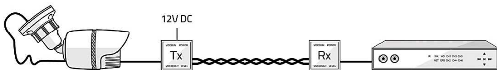
kamera AHD skrętka komputerowa - kabel UTP kat. 5e/6 rejestrator AHD przesył do 500m przy 720p przesył do 300m przy 1080p
